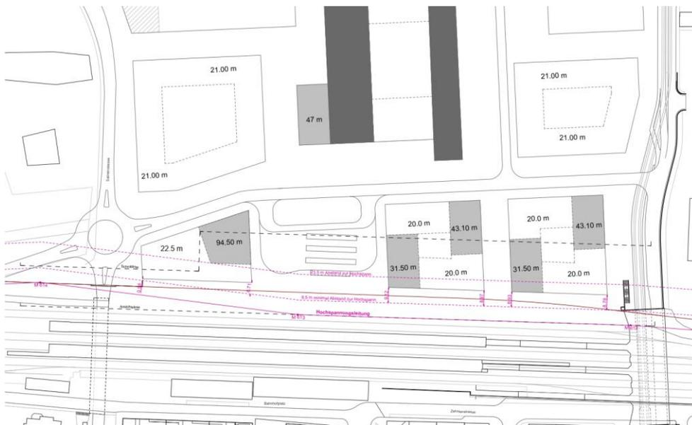
Abbildung 48 Abstände gemäss Leistungsverordnung (Situation). Dargestellt sind die Abstände ab der Achse der Leitung. Der unterste Leiter befindet sich in einem Abstand von 3.5 m von der Achse.
