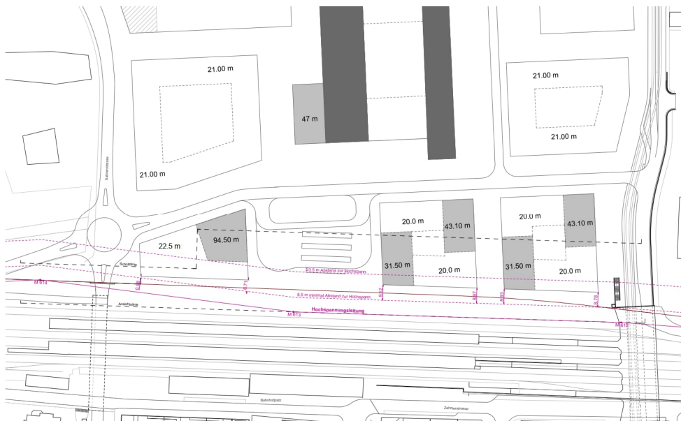
Abbildung 48 Abstände gemäss Leitungsverordnung (Situation). Dargestellt sind die Abstände ab der Achse der Leitung. Der unterste Leiter befindet sich in einem Abstand von 3.5 m von der Achse.
