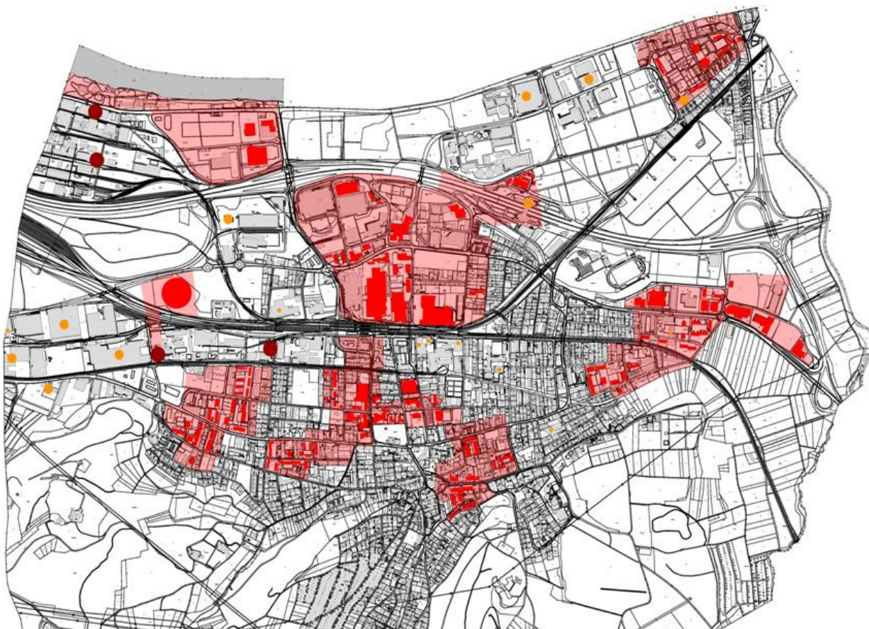
Abbildung 6: Standorte Feuerungsanlagen über 500 kW sowie bestehende Wärmeverbünde; Prozesswärme dunkelrote Punkte; Raumwärme (und Warmwasser) dunkelgelbe Punkte; < 1 MW kleiner Punkt, 1 – 10 MW mittlere Punktgrösse; > 10 MW grosser Punkt
